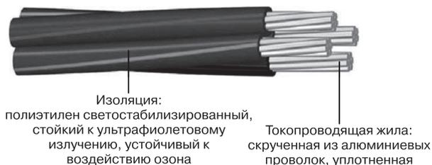
**Рис. 4.4.** Самонесущий изолированный провод СИП: конструкция
