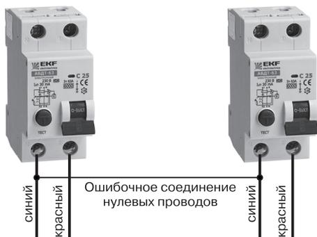
*Рис. 9.11. Первая ошибка: соединение нулевых проводников, идущих через разные защитные устройства*
