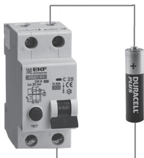
Рис. 9.8. Проверка электромеханического АВДТ-63
